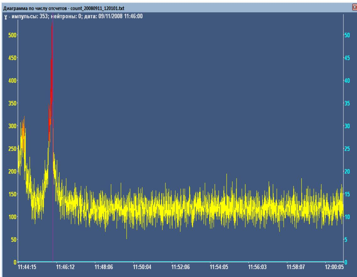
Программа отображает данный профиль скоростей счета нейтронного и гамма-излучения и позволяет соотнести скорость счета нейтронного и гамма-излучения, полученную в определенный момент времени, с аппаратным спектром гамма-излучения и соответственно географическим положением точки регистрации данной скорости счета нейтронного и гамма-излучения.
