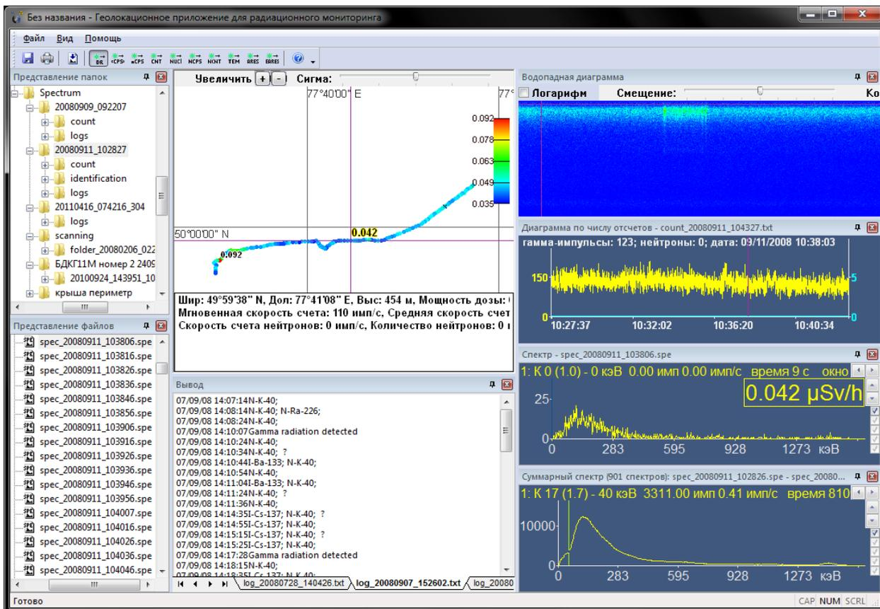
Функционал сканера позволяет выполнять географическую привязку на местности позиции набора аппаратурного спектра гамма-излучения используя приемную систему глобального спутникового позиционирования (GPS).
