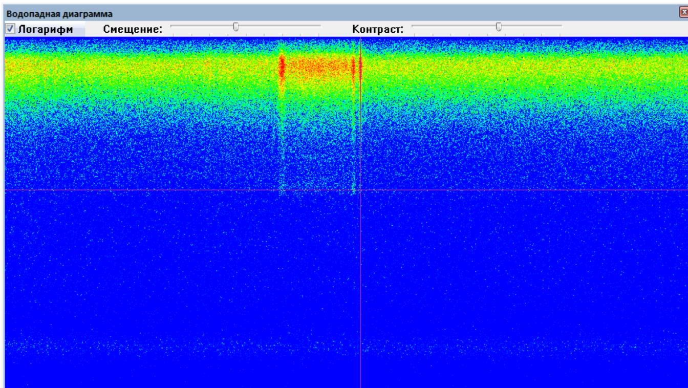
По вертикали: сверху вниз – номера каналов аппаратурных спектров гамма-излучения.
